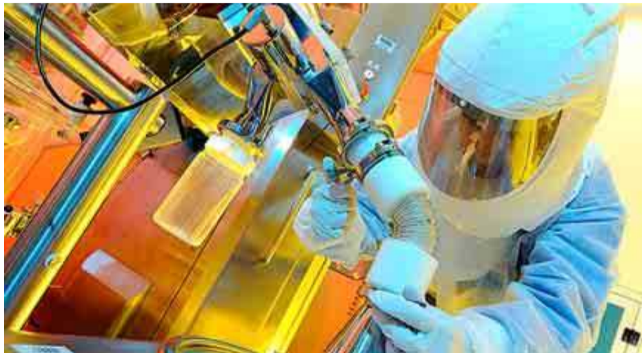
En la imagen, un profesional de Cinfa supervisando el proceso de compresión de medicamentos, en el que el granulado se somete a presión para obtener los comprimidos. Se controlan en tiempo real el cien por cien de los comprimidos producidos y se realiza también control estadístico de peso, dureza y dimensión.
